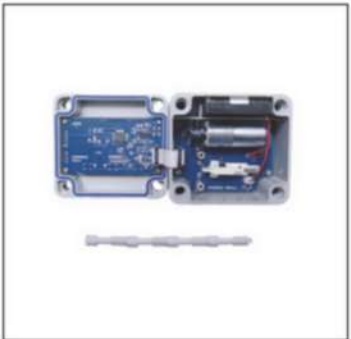
4. Ouvrez le panneau avant du contrôleur et retirez le support de batterie. Insérez 4 piles AA dans le support de piles et reconnectez.
