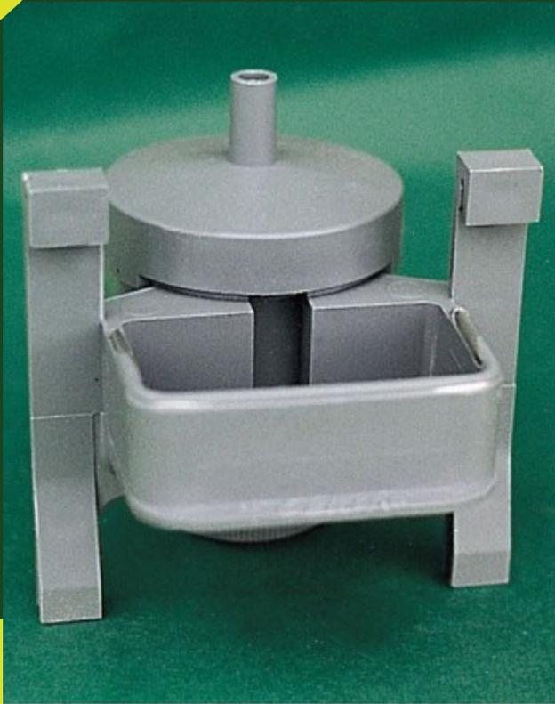
Abreuvoir mod. Spain avec remplissage automatique (pour lapins, pigeons, etc.). Grâce au flotteur interne, il se recharge automatiquement par chute d'un récipient externe relié par un tube. Pour le fixer, il est nécessaire de couper le grillage près de la cuvette, puis de l'accrocher.
